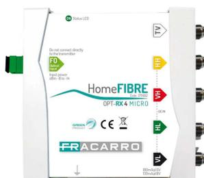
Il ricevitore **OPT OPT-RX 4 MICRO** converte il segnale ottico di ingresso in segnale coassiale disponibile sulle 4 polarità satellitari (VL, HL, VH, HH) e una uscita TV indipendente disponibile sul connettore coassiale dedicato. Il ricevitore può essere alimentato direttamente dalle polarità di uscita. Il prodotto è dotato di un LED verde multifunzione che fornisce all'installatore diverse informazioni:
